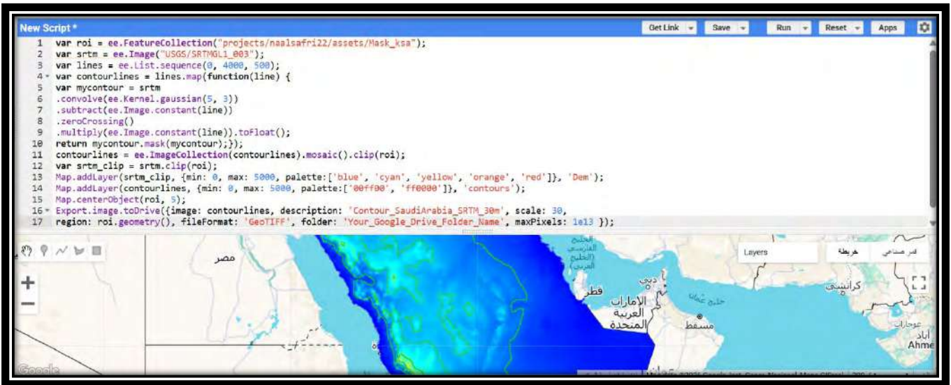
شكل (12): إدراج وتشغيل كود استدعاء نموذج الارتفاع الرقمي (DEMSTRM30) وإجراء تحليل استخراج الكنتور بفواصل كنتوري (500م) على منصة GEE.
